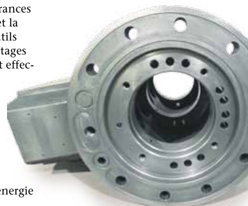
Corps de pompe d'injection avec canaux moulés, très filiformes
